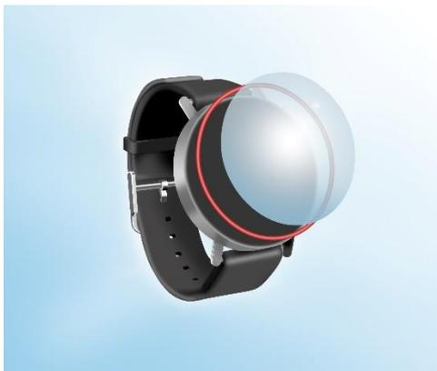
圖 1：智慧型手錶機殼和觸控顯示器間是密封防水的。使用 Manz 的解決方案，紅色的黏著劑完全自動填料，透過雷射活化，再將蓋板玻璃壓合於上方。
