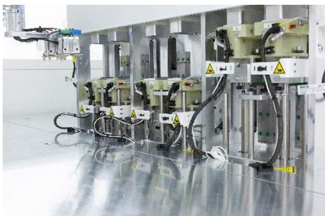
圖 2：Manz 顯示器密合系統上料介面，搭載三個可變換且具緩衝的預加熱衝壓單元。
