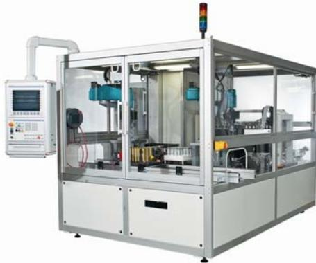
Cell to system: Montage einzelner Zellen in Batteriesysteme (Quelle: Manz Automation)
