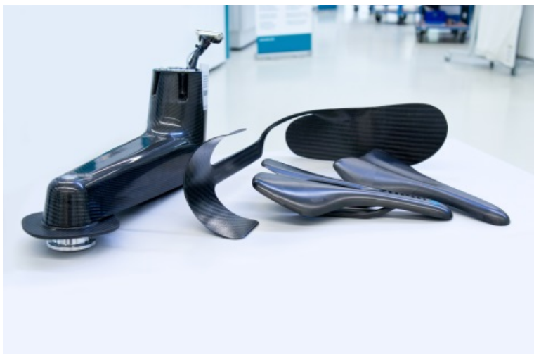
Foto 2: Patch Placement wird nicht nur in der Medizintechnik eingesetzt, sondern auch in der kundenindividuellen Massenproduktion in der Schuhindustrie oder zur Fertigung maßgeschneiderter Sportgeräte.
