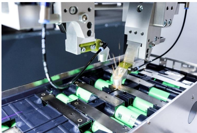
Bildunterschrift: Laser Tab Welding Prozess mit der BLS 500
