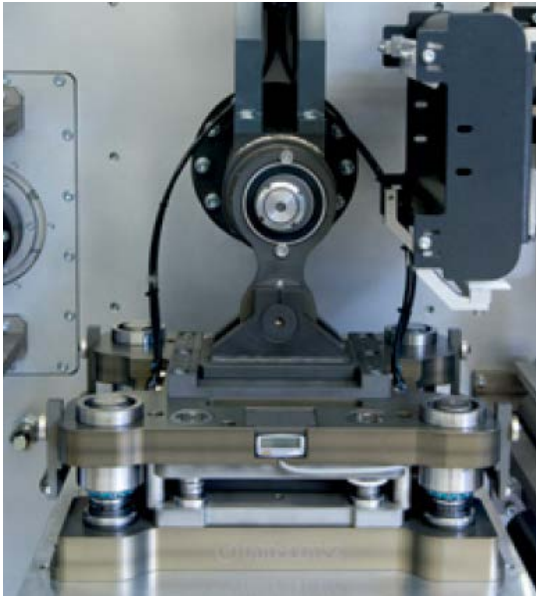
图 1：高速模切平台的加工模块，Manz 掌握了采用机械或激光切割方法的各种模切工艺。
