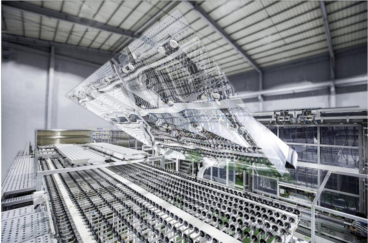
Manz 開發的輕量化碳纖維抓取系統可確保最大的穩定性以及低振動。
