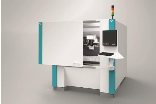
Bild 1: Neu im Manz-Katalog: das Battery Laser System BLS 500 zur Fertigung von Li-Ion-Batterien ist individuell konfigurierbar. Basis dafür ist die Standardisierung einer Vielzahl von Modulen.
