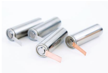
Bild 2 & 3: Das BLS 500 ist das Schweizer Laser-Offiziersmesser des Hightech-Maschinenbaus: Laserschweißen von gleichen oder unterschiedlichen Metallen sowie von reflektierenden Materialien; Technologiesprünge oder neue Materialkombinationen erfordern höchste Flexibilität in der Fertigung von Li-Ion-Batterien.
