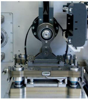
图 1：复合方式锂离子软包电池标准生产线中模切部分示意图：MANZ 高速模切平台为单独电极或电极卷的生产提供高效解决方案
